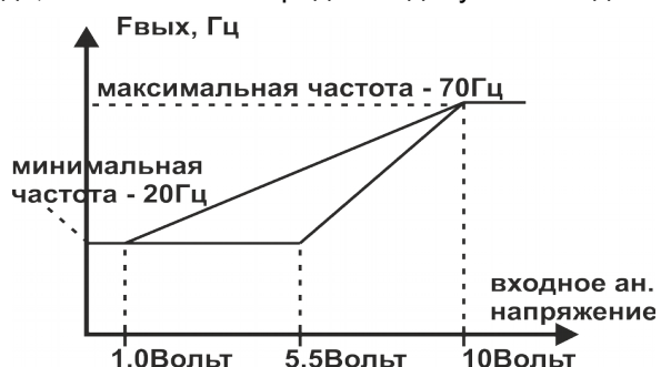
Рисунок 12. Масштабирование AN.IN по нижней границе диапазона сигнала.
