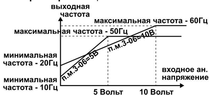
Рисунок 13. Масштабирование AN.IN по верхней границе диапазона сигнала.
